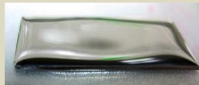
磁場による、有機半導体溶液の形状変化（モーゼ効果）
